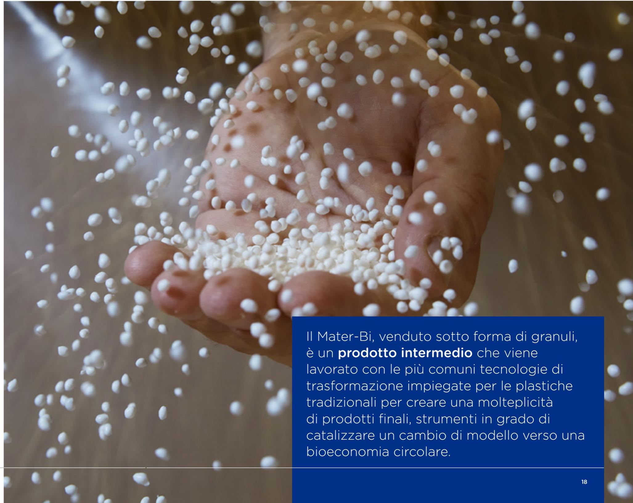
Il Mater-Bi, venduto sotto forma di granuli, è un **prodotto intermedio** che viene lavorato con le più comuni tecnologie di trasformazione impiegate per le plastiche tradizionali per creare una molteplicità di prodotti finali, strumenti in grado di catalizzare un cambio di modello verso una bioeconomia circolare.
